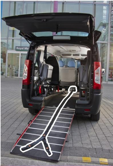
**Ax-s Winch compact** est un treuil spécifiquement conçu pour assister mécaniquement les accompagnateurs d'utilisateurs en fauteuil roulant à franchir l'obstacle de la rampe pour accéder dans un véhicule.
