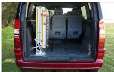
Pivotement intérieur de la rampe
