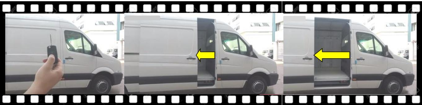
Ouverture et fermeture automatique en appuyant sur un seul bouton.
