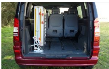
Pivotement intérieur de la rampe
