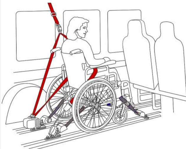
La ceinture de sécurité 3 points pour l'occupant est généralement composée de:
