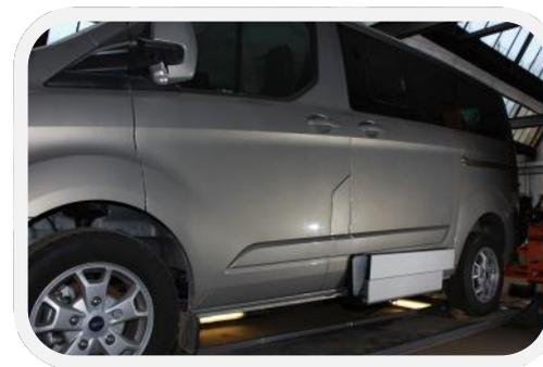
« **Step-Up** » se **déploie simultanément avec l'ouverture de la porte** latérale coulissante. Après la fermeture de la porte, **Step-Up reprend automatiquement à sa position verticale initiale**.
