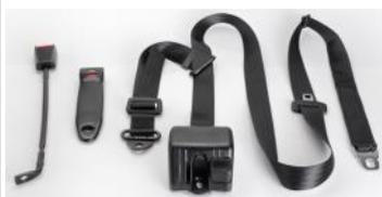
SLR107: Ceinture de sécurité à enrouleur 3 points avec pédoncules:
