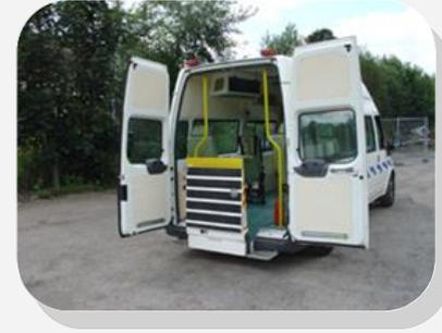
La rampe se transforme en une **rampe de 12° en moins de 10 secondes.**
