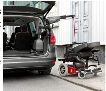
2. La **plateforme élévatrice Joey Lift** : située à l'arrière du véhicule permet de soulever et charger le fauteuil roulant dans un véhicule. Vous roulez et fixez simplement le fauteuil roulant sur la plateforme depuis l'extérieur du véhicule, vous appuyez sur la télécommande et c'est tout. L'élévateur Joey est une des solutions les plus compactes du marché et ne gêne pas du tout la banquette arrière.
