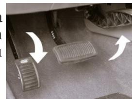
**Accélérateur pied gauche, modèle à fixation rapide** : **contrôle mécanique de l'accélérateur d'origine du véhicule**. La pédale peut facilement être retirée pour retrouver l'équipement d'origine. Conception universelle pouvant être installée sur les véhicules avec conduite à droite ou à gauche, et sur la plupart des marques et des modèles de véhicules.
