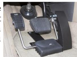
**Rehausseur de pédale avec plancher** : permet une **extension de 10 - 30 cm**. Le rehausseur peut être réglé en termes de distance, de hauteur et d'espace souhaité entre les pédales. Les rehausseurs sont également dotés d'un système de fixation rapide, permettant de les retirer facilement. Peuvent être installés sur les véhicules automatiques et manuels.
